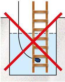
Imagen 4. Nótese que el flotador debe poder moverse libremente.
